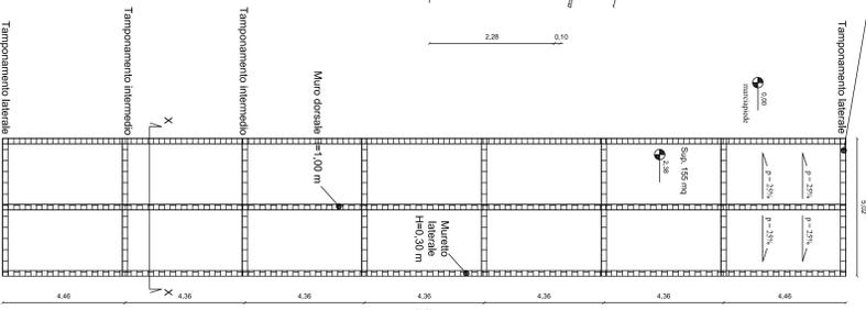
PARTICOLARE SOLAIO CON TRAVETTI IN CAP 12x4 cm
