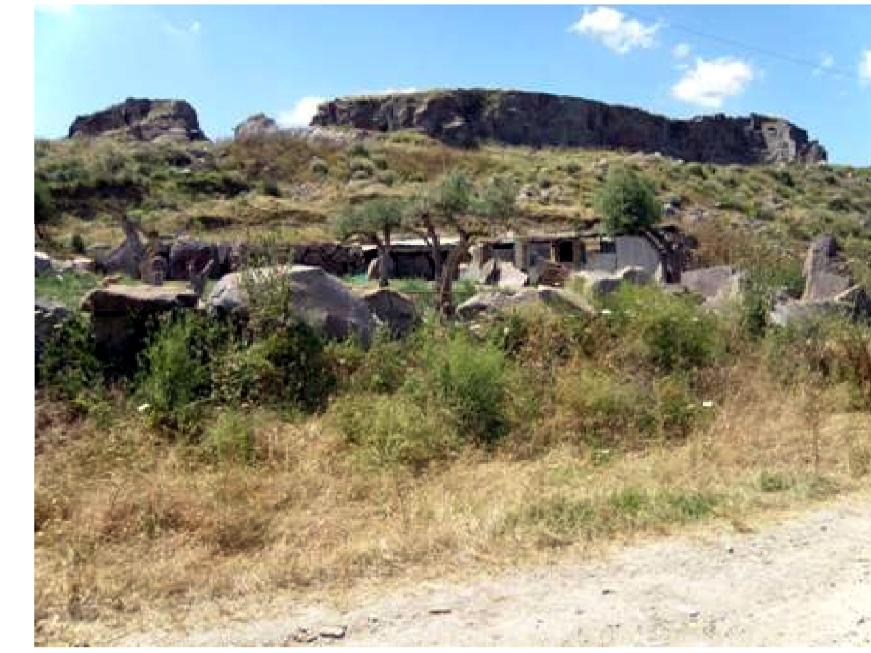
Sez B-B1: Scarpate di cava nel versante nord del Monte Atzorcu. I rilievi di Monte Atzorcu e di Monte Iibera rappresentano, nella loro struttura geologica profonda, dei domi vulcanici di composizione andesitica ricoperti da depositi di flusso piroclastico in facies ignimbritica di spessore variabile dai 5 ai 15 metri. Tali depositi piroclastici sono oggetto di coltivazione. L'immagine evidenzia il fronte di cava visibile alla sommità del Monte Atzorcu. Le aree dei rilievi ignimbritici soggette ad attività di cava sono state classificate con livello di pericolosità Hg4.
